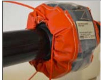
5. Asegurar el protector a la conexión de la tubería con fuerte nudo en los cordones.
